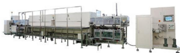
水平搬送UP/DOWN方式 電気銅メッキ装置
