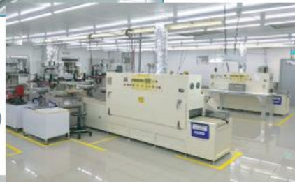
*第2シルク印刷工場 クリーン環境下での印刷対応 2nd SILK PRINTING / Production (Clean Environment Class <10000)
