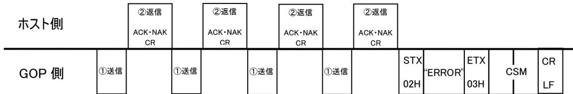
リトライ処理に関しては、一度送信後、1秒以上返信の無い場合、又は、NAKの返答の場合に、再度送信を行います。3度リトライを行った結果、通信が正常に終了しなかった場合は、"ERROR"を送信し、エラー画面を表示します。
