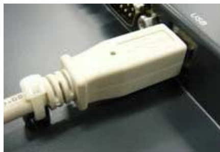
USB ケーブルをタイラップにて固定した状態
